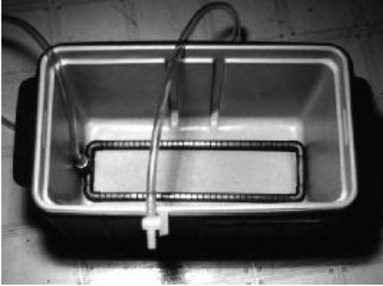
Şekil 92: Bu açıdan bakır boruya açılmış olan yarıkları görebilirsiniz. Bakır borunun tasarımı Ek D'de anlatılmaktadır.
