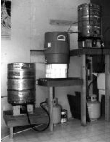
Şekil 94 & 95: Bu iki tür haşlama/süzme sistemi üç katlıdır, serbest düşme ilkesiyle çalışır. Eğer termos/buzluk kullanıyorsanız üç katlı sisteme gerek kalmaz, benim yaptığım gibi yapılır. Bu haşlama
