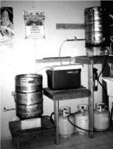
Şekil 94 & 95: Bu iki tür haşlama/süzme sistemi üç katlıdır, serbest düşme ilkesiyle çalışır. Eğer termos/buzluk kullanıyorsanız üç katlı sisteme gerek kalmaz, benim yaptığım gibi yapılır. Bu haşlama
