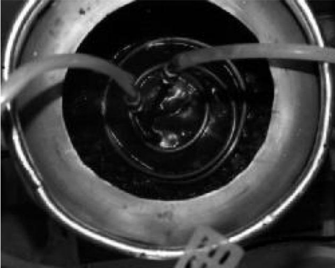
Şekil 106: Soğumuş şerbetin üstten görünümü. Şerbetçiotları serpantinin kenarlarında yüzmekteler.
