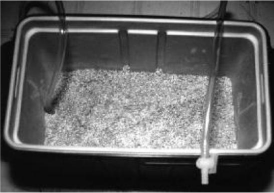
Şekil 93: Bakır borunun üstü doldurulmuş durumda. Süzme kabını nasıl tasarımlayacağınız nasıl bir süzme yapmak istediğinize bağlıdır.
