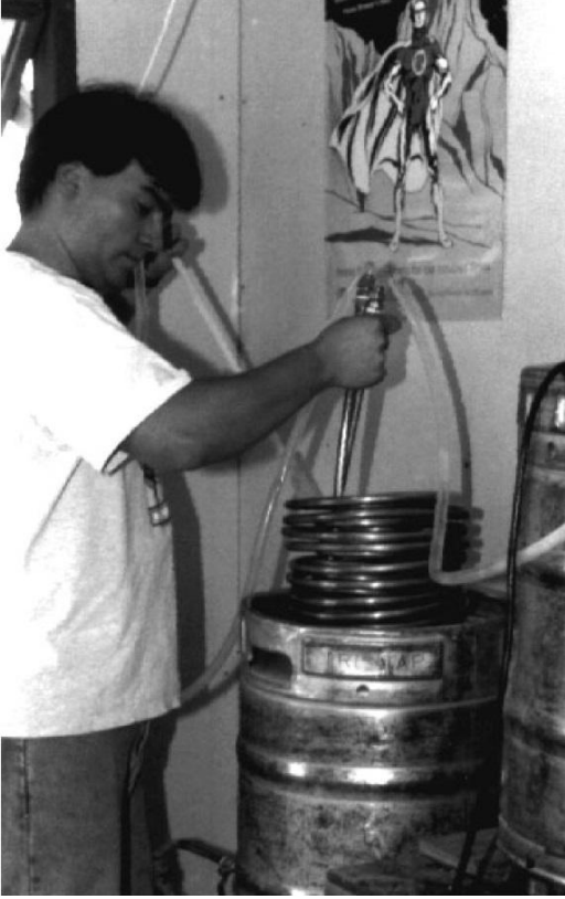
Şekil 105: Şimdi kaynama işlemi bitti ve şerbeti soğutma aşamasına gelindi. Evbiracısı Joe 23 litre sıcak şerbeti soğutmak için büyük bir serpantin kullanmakta.
